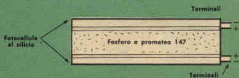
Fig. 5 - Pila al prometeo composta da una parte centrale di prometeo e fosforo circondata da fotocellule.
