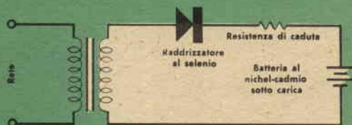
Fig. 4 - Tipico e semplice circuito raddrizzatore usato per riattivare batterie ricaricabili.
